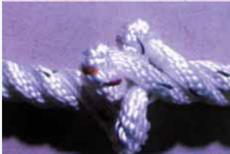
Abb. 4: Krangelbildung bei einem neuen Seil
