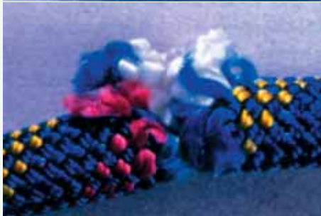
Abb. 11: Schnittverletzung bei einem Kern-Mantel-Seil
