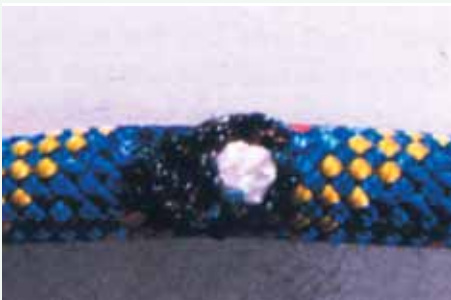
Abb. 13: Anschmelzstelle bei einem Kern-Mantel-Seil
