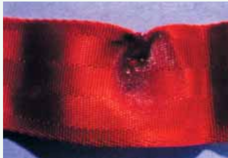
Abb. 16: Anschmelzstelle an einem Gurtband
