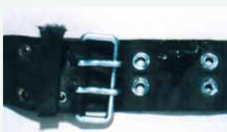
Abb. 15: Durchtränkung mit Klebstoff, gerissene Schlaufe und beschä- digte Ösen
