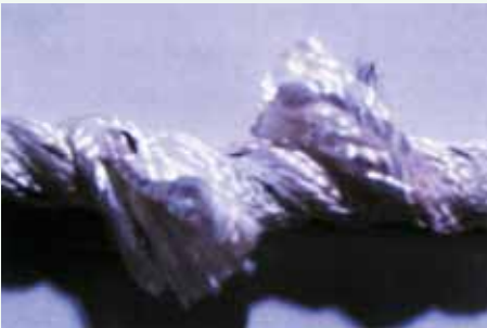
Abb. 7: Schnittverletzung bei einem gedrehten Seil; eine ganze Litze ist durchtrennt
