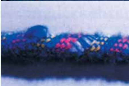
Abb. 12: Abscheuerung bei einem Kern-Mantel-Seil
