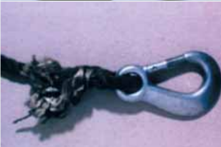
Abb. 8: Gelockerter Spleiß und fehlende Karabinersicherung
