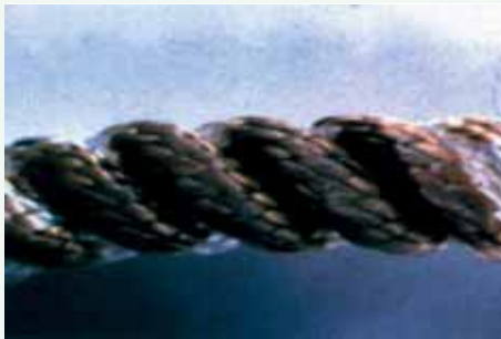
Abb. 9: Eindringen von Schmierstoff bis ins Seilinnere (in Bild- mitte)
