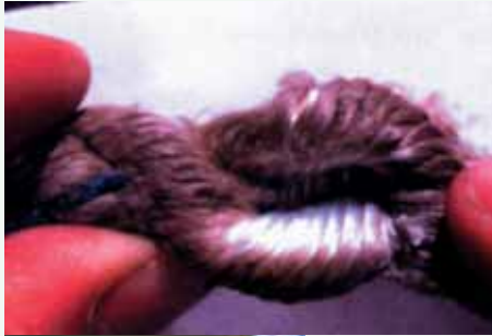
Abb. 1: Aufdrehen eines Seiles zur Beurteilung des Seilinneren
