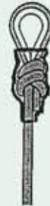
geflochtenes Seil mit Spirenstich u. Kau- sche: Nur Kunst- stoffkauschen, mit Schrumpfschlauch gesichert
