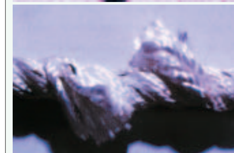
Abb. 7: Schnittverletzung bei einem gedrehten Seil; eine ganze Litze ist durchtrennt
