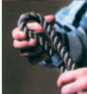
Abb 2: Prüfung der Schmiegsamkeit: Der Innendurchmesser muss etwa dem Seildurchmesser entsprechen (die Schlaufe muss ohne Kraftaufwand gebildet werden können)
