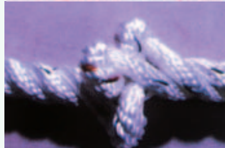
Abb. 4: Krangelbildung bei einem neuen Seil
