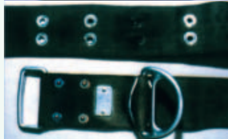
Abb. 17: Ausgerissene und be- schädigte Ösen, ver- bogene Metallteile nach Sturzbelastung oder missbräuch- licher Verwendung
