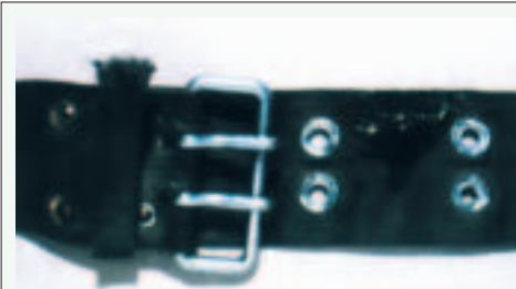
Abb. 15: Durchtränkung mit Klebstoff, gerissene Schleife und beschä- digte Ösen
