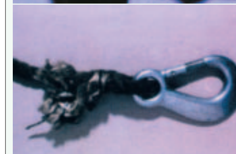
Abb. 8: Gelockerter Spleiß und fehlende Karabinersicherung
