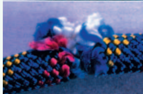
Abb. 11: Schnittverletzung bei einem Kern-Mantel-Seil
